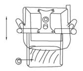
Befestigen Sie die beiden Armlehnen (C) mithilfe der Schrauben unter der Sitzfläche (D). Achten Sie hierbei auf die vorgebohrten Löcher.
