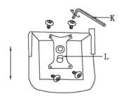
Befestigen Sie die Mechanik (L) unter der Sitzfläche mit den dafür vorgesehenen Schrauben und ziehen Sie diese mit dem Imbus-Schlüssel (K) fest.
