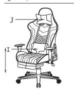
Stecken Sie die Sitzfläche mit den montierten Armlehnen auf die Gasdruckfeder. Bitte prüfen Sie, dass alles richtig installiert ist und nicht schief steht.
