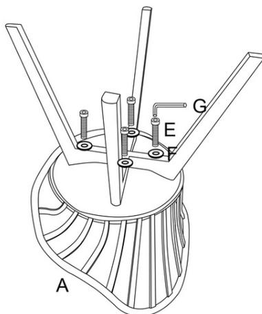
Schrauben Sie *die größeren Schrauben (E)* zusammen mit den *Unterlegscheiben (F)* in die dafür vorgesehenen Löcher an. Verwenden Sie dabei den mitgelieferten *Imbus-Schlüssel (G)*. Ziehen Sie dann alle Schrauben fest.
